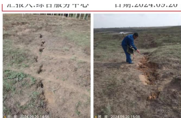
照片 3-1 3、5、9 煤层采空区对应地表塌陷治理照片
