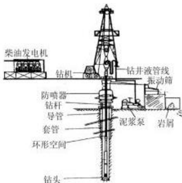
图2-7 钻井作业示意图
